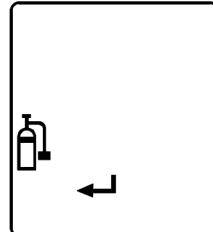
這是一個快速的校正程序，且須在兩分鐘內完成；在校正終點，顯示幕將於波寬讀值和通過(P)/失敗(F)指示之間閃爍 10 秒鐘。在過程中的任何點要終止校正，按 鍵。
