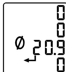
當 CO、H<sub>2</sub>S 和 LEL 感應器已完成歸零過程，氧氣感應器將開始定波寬；於此過程中， 圖像和氧氣滿波寬的數值將被顯示。
