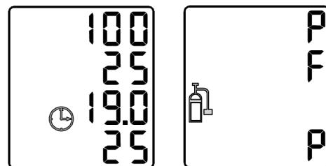
M40 的校正用標準氣體是混合的數值，你必需要用含有 25 ppm H<sub>2</sub>S、100 ppm CO、25%LEL 甲烷或 50%LEL 戊烷、和 19% 氧氣的混合氣體鋼瓶以每分鐘 500 毫升的流量校正該儀器。
